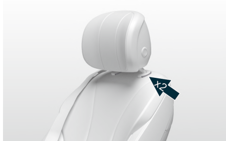
图示: 拆卸头枕
