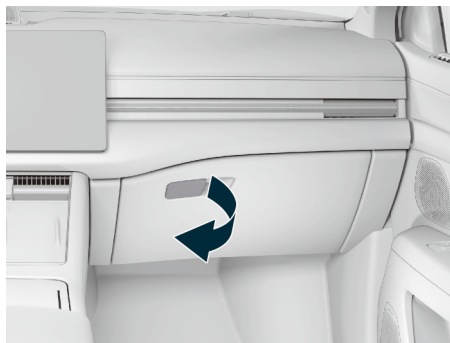
图示: 手套箱开启手柄
