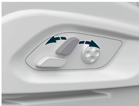
图示: 靠背倾斜角度调节按键
