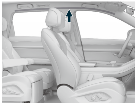
图示: 帘式气囊位置
