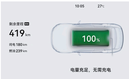
图示：仪表显示充电信息（不同版本存在差异，请以实车为准）
