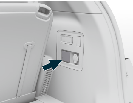
图示: 后备箱内的 220V 电源
