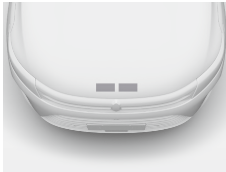
图示: 前机舱盖按压位置
