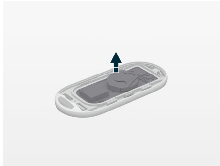
图示：取出遥控钥匙电路板
