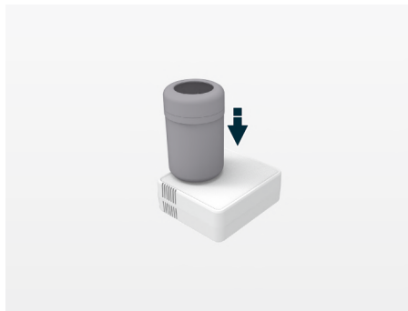
图示: 安装补胎液罐
