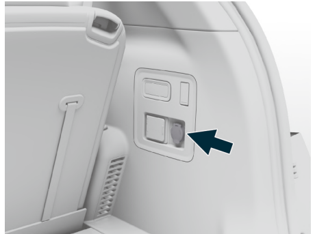
图示: 后备箱内的 12V 电源
