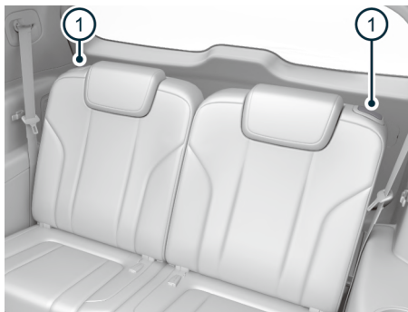
图示: 第三排座椅调节拉手
