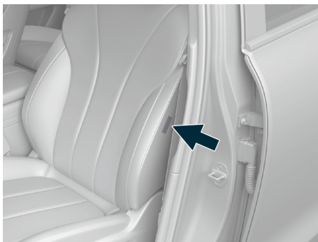
图示: 前排座椅和第二排座椅侧气囊位置
