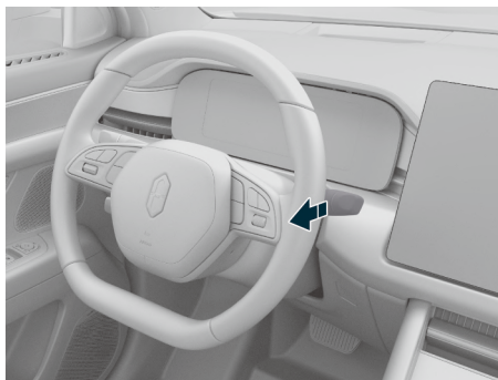
图示: 前挡风玻璃洗涤
