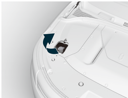
图示: 洗涤壶注水口
