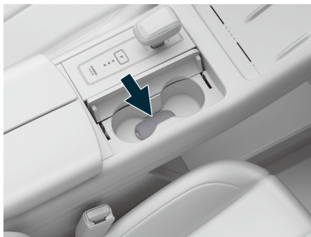
图示: 应急模式遥控钥匙放置位置
