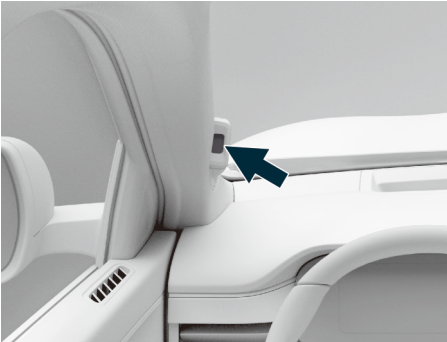
图示: 驾驶员状态监测摄像头位置
