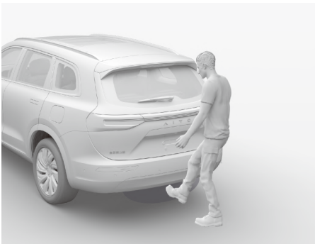
图示：脚部移动检测传感器位于保险杠下方
