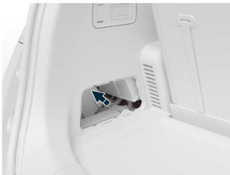
图示: 充电枪应急解锁拉线
