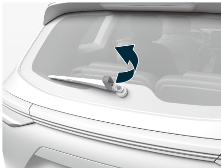
图示: 更换后雨刮片
