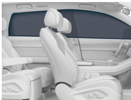
图示: 帘式气囊展开情形
