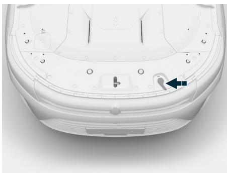
图示: 前机舱盖打开手柄
