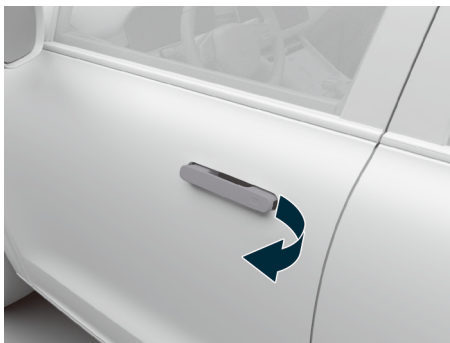
图示: 使用车门外把手解锁
