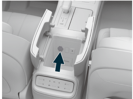
图示: 前排扶手箱内的 12V 电源
