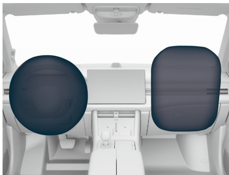
图示：正面安全气囊展开情形
