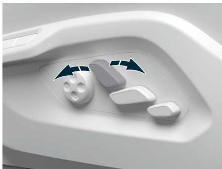
图示: 靠背倾斜角度调节按键
