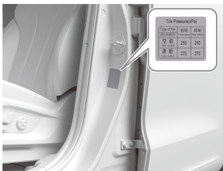
图示: 轮胎胎压位置 (图片位置仅供参考, 具体情况请以实车为准)
