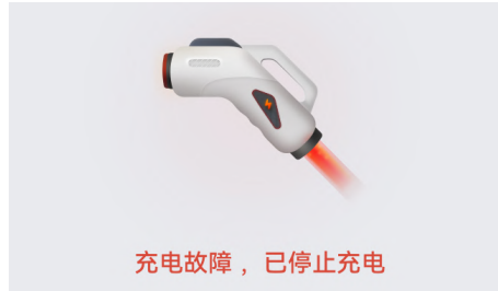
图示：仪表弹窗充电故障显示（不同版本存在差异，请以实车为准）
