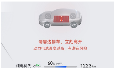
图示：仪表显示屏动力电池过温警示（不同版本存在差异，请以实车为准）
